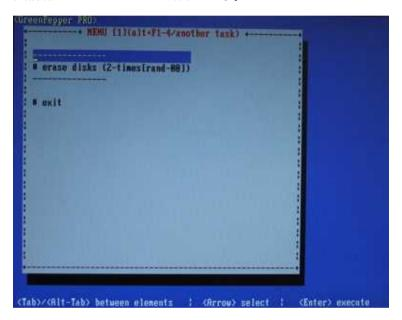
「# erase disks (2-times[rand-00])」の項目に青い範囲が移動するまで、キーボードの矢印キーで操作をし、「Enter」キーを押します。(「 」キー 1 回押せば下に移動します。)
