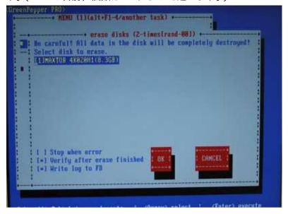
「tab」キーを1回押して、「OK」の項目を選択状態(白くなります。)にして「Enter」キーを押します。
